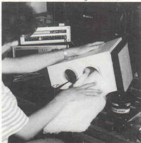
▼ Das Dämmmaterial muß den Innenraum locker aber vollständig ausfüllen.
