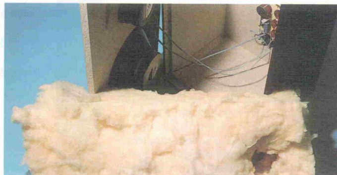
Gut erkennbar: Das Baßreflexrohr wurde durch das Dämmaterial hindurchgedrückt.
